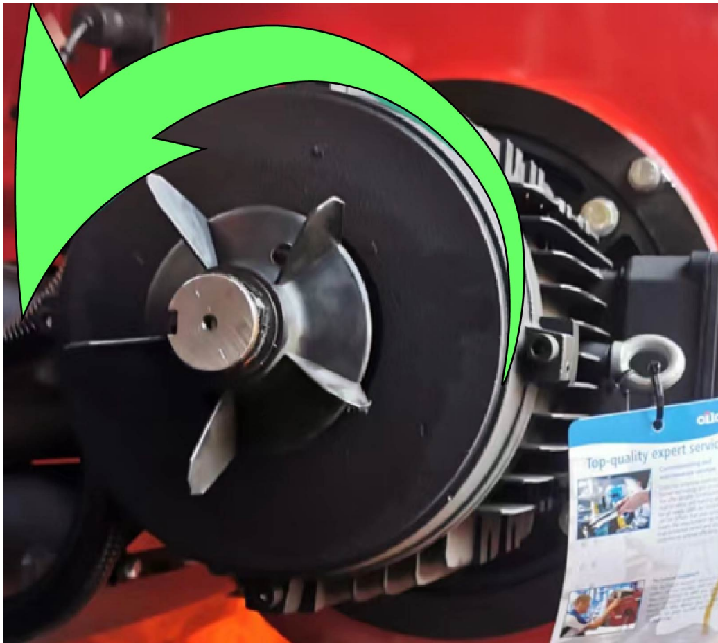
Motor cooling fan impeller rotation ver. 1
