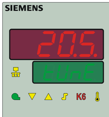
Kuva 23: Automaattisen säätötoiminnon näyttö
